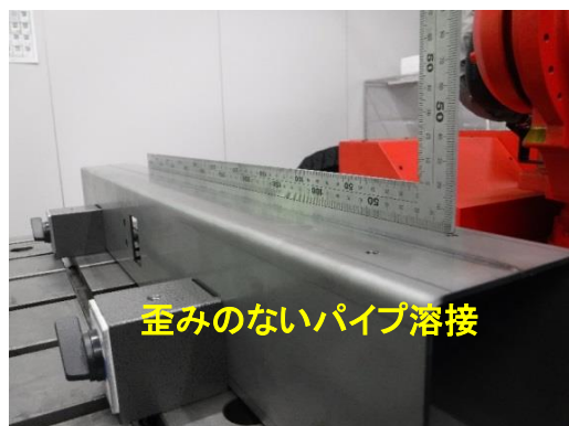
レーザー光で隅まで溶接が可能 (非接触)
