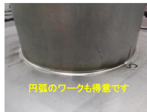
レーザー光で隅まで溶接が可能 (非接触)
