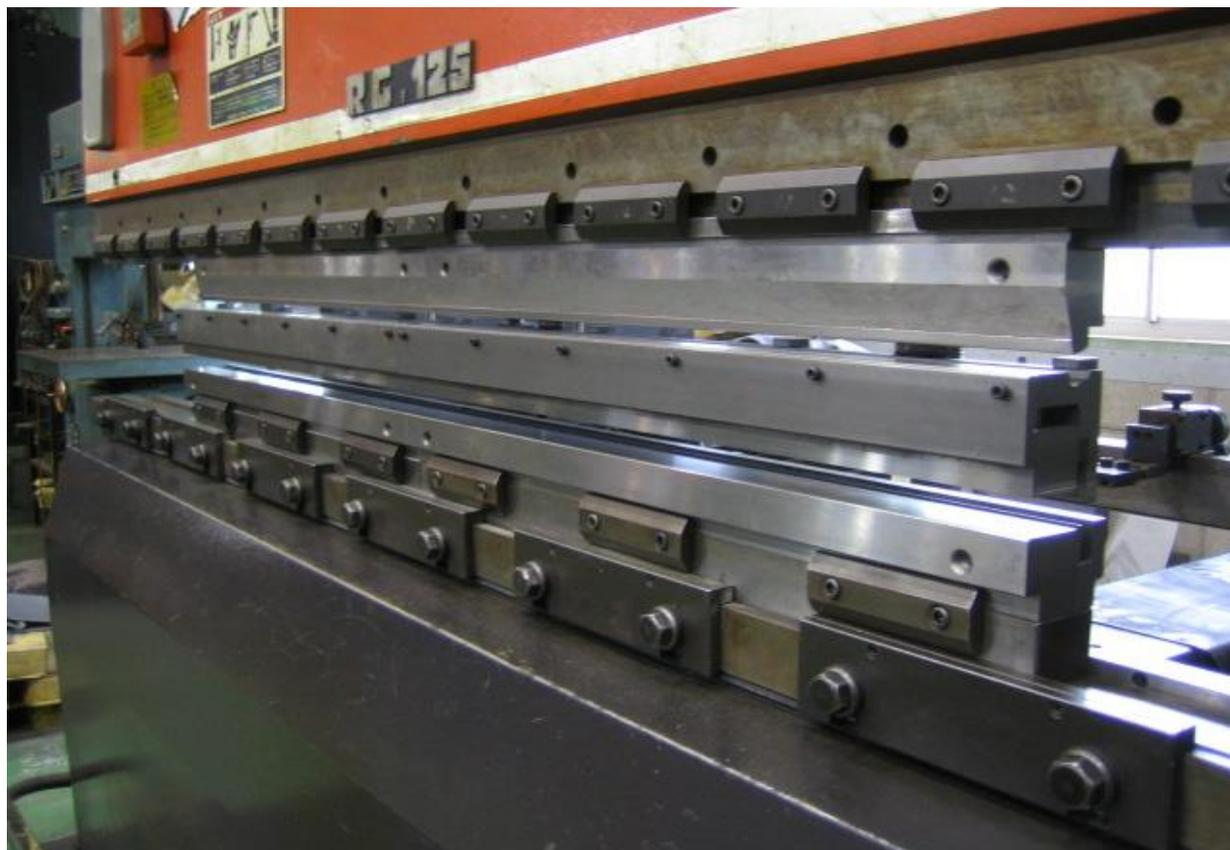
カーリング金型を新調しました。先代のカーリング金型は30年以上使い続けてさすがに寿命がきたのか、カーリングの巻き・寸法が安定せず、作業のボトルネック要因となっていました。そこで今後の展開も考慮に入れて、RG125(Z I 型)だけでなくZ II 型ベンダーにも流用できるように設計された金型を導入。
